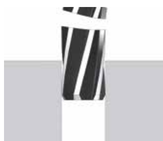
Reibahle klemmt und bricht
