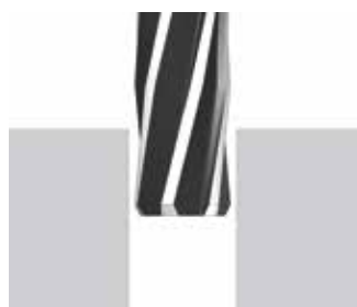
Bohrung wird zu groß
