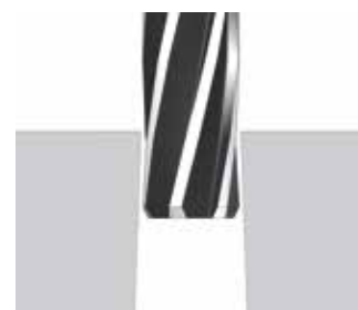
Konische Bohrung (Ende zu groß)
