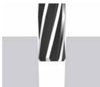
Konische Bohrung (Eingang zu groß)
